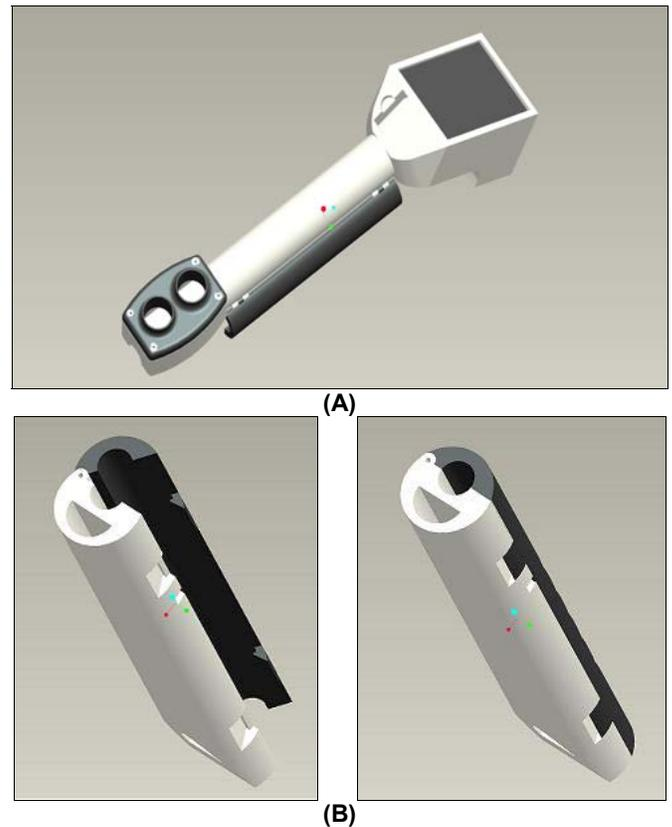
**FIGURE 11: PROTOTYPE OF THE DEVICE A) TOP VIEW B) SNAP-FIT ARRANGEMENT USED FOR LOCKING**
